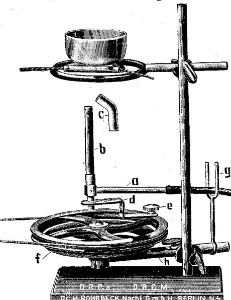
das senkrechte Brennerrohr eintritt. Dann ist der eigentliche Überdruck des Gases gegenüber der umgebenden Luft aufgehoben. Die brennende Flamme wirkt vielmehr saugend auf das Gasluftgemisch, so daß bei etwaigen Undichtigkeiten zwischen Brenner- und Zuführungsrohr kein Gas nach außen entweichen kann.
